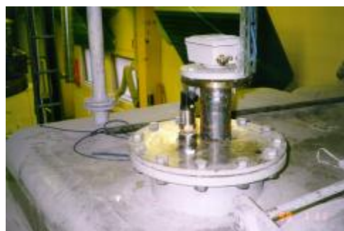
Pomiar poziomu farby miernikiem w wersji EEx ia w zakładzie chemicznym
